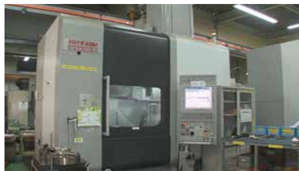
タテ型 NC 複合研磨機 TAIYO KOKI Vertical Mate 85 旋回テーブル径 850 mm
