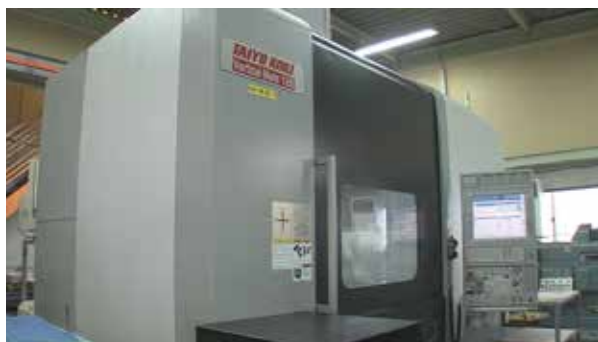
タテ型 NC 複合研磨機 TAIYO KOKI Vertical Mate 125 旋回テーブル径 1250 mm
