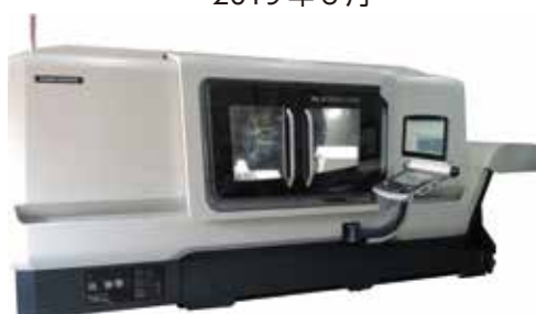
高剛性・高精度 CNC 旋盤 (Y軸機能 + ミーリング機能付き) 森精機 NLX2500Y/1250 2018年6月29日
