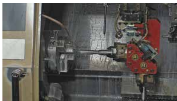
シャフト加工専用ガントリー式ローダー付CNC旋盤 ワーク長 30 mm から 300mm に対応
