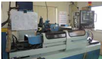
旋回テーブル径 1250mm 内径・外径・上端面の研削
